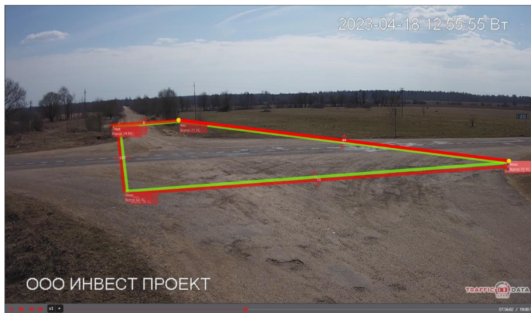
Рисунок 2.8.11 – Скриншот видео и схема подсчета интенсивности на узле № 10 – а/д Алешино-Диево - Курьяново
