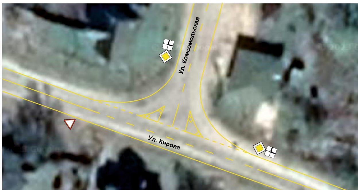
Рисунок 3.2.4 – Предлагаемая схема ОДД на узле 4 – С. Киверичи ул. Кирова – ул. Комсомольская
