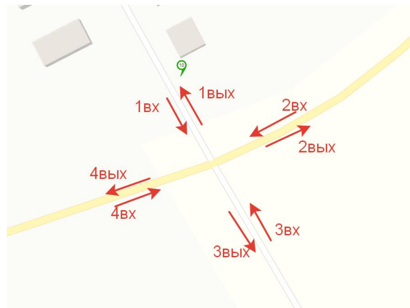
Рисунок 2.8.11 – Скриншот видео и схема подсчета интенсивности на узле № 10 – а/д Алешино-Диево - Курьяново
