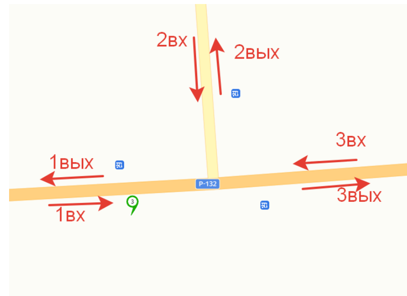
Рисунок 2.8.4 – Скриншот видео и схема подсчета интенсивности на узле № 3 – а/д Р-132 Золотое кольцо - а/д 28Н-1286 «Красный Пахарь – Ильгощи – Волосково»
