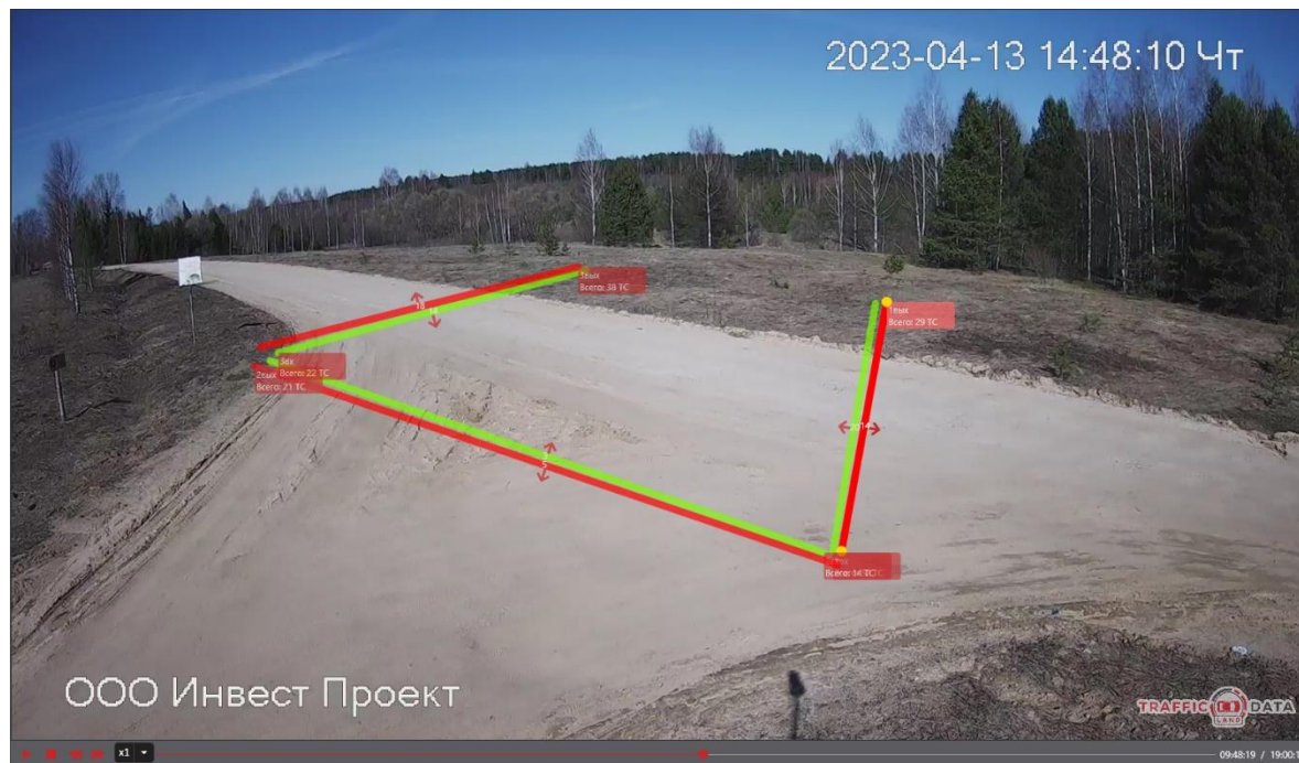
Рисунок 2.8.3 – Скриншот видео и схема подсчета интенсивности на узле № 2 – а/д 28Н-1274 «Киверичи - Городня - Ивановское - Быково» - а/д подъезд к д. Берковщина
