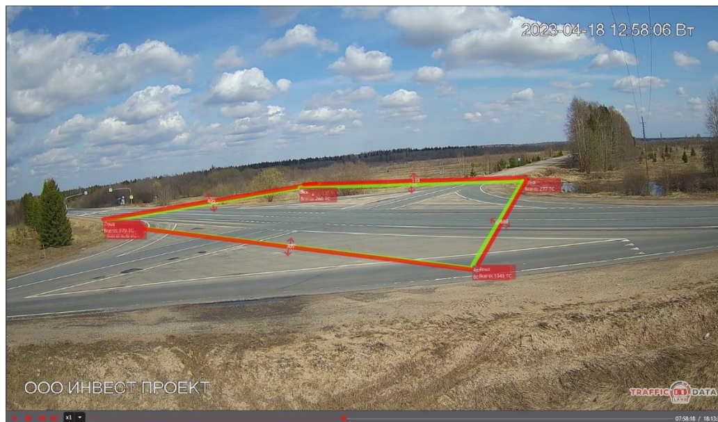
Рисунок 2.8.9 – Скриншот видео и схема подсчета интенсивности на узле № 8 – а/д 28К-0058 «Тверь - Бежецк - Весьегонск - Устюжна» - а/д 28Н-1268 «Ильино - Буйлово - Киверичи»
