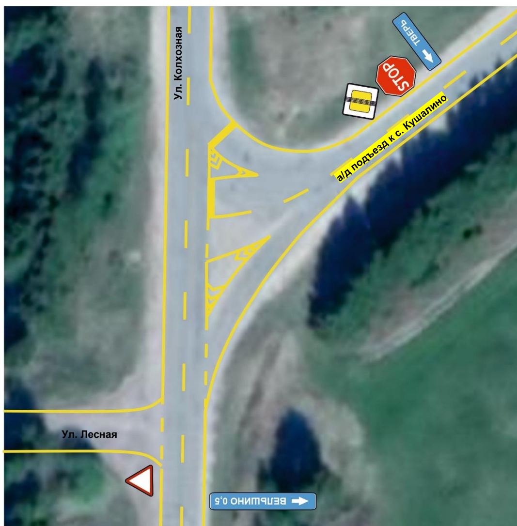
Рисунок 3.2.1 – Предлагаемая схема ОДД на узле 1 – а/д подъезд к с. Кушалино - ул. Колхозная -ул. Лесная
