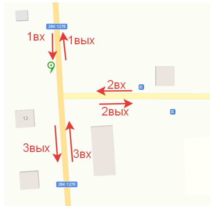
Рисунок 2.8.10 – Скриншот видео и схема подсчета интенсивности на узле № 9 – а/д 28 28Н-1268 «Ильино - Буйлово - Киверичи» - а/д 28К-1278 «Прудово - Рамешки - Заручье»
