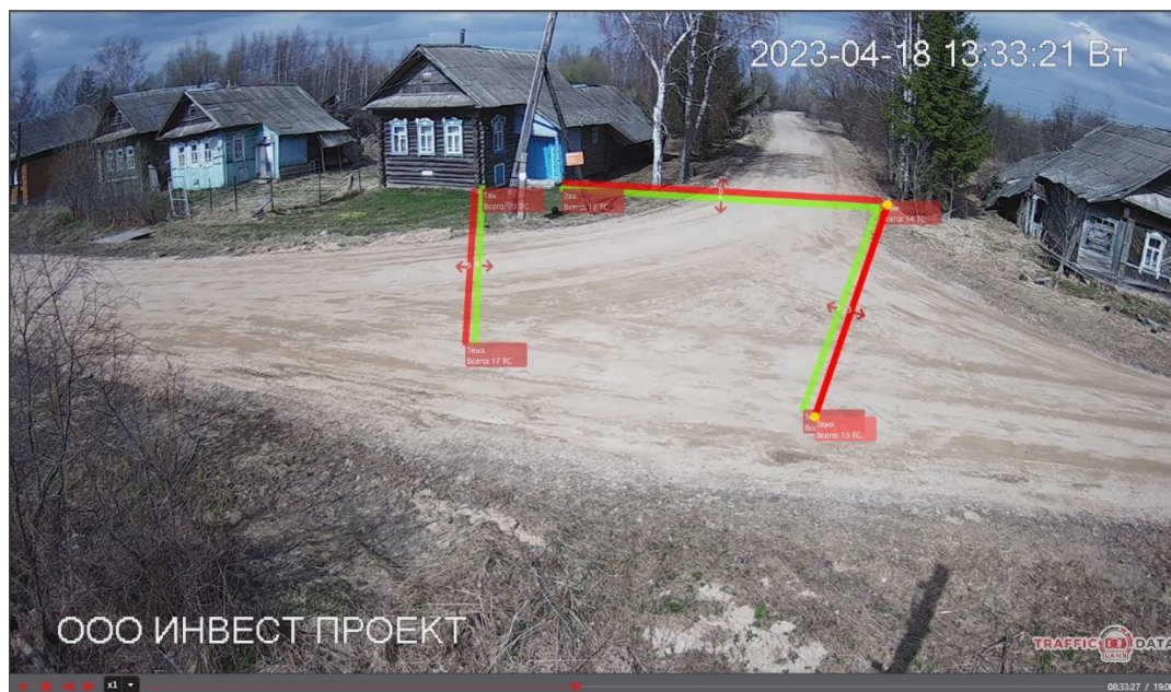
Рисунок 2.8.17 – Скриншот видео и схема подсчета интенсивности на узле № 15 – д. Лядины (28Н-1303)
