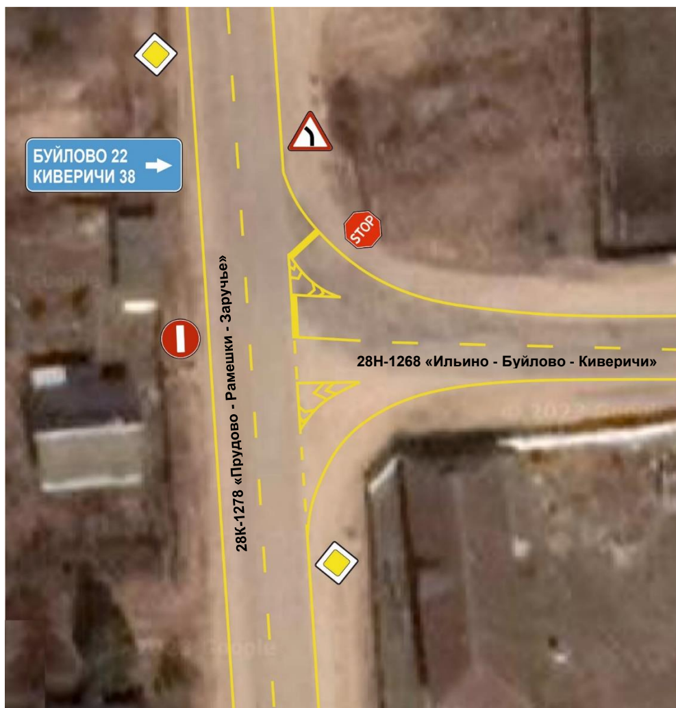
Рисунок 3.2.3 – Предлагаемая схема ОДД на узле 3 – а/д 28Н-1268 «Ильино - Буйлово - Киверичи» – а/д 28К-1278 «Прудово - Рамешки - Заручье»
