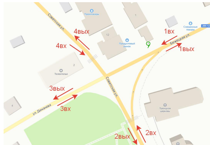
Рисунок 2.8.8 – Скриншот видео и схема подсчета интенсивности на узле № 7 – ул. Советская - ул. Дюканова - ул. Бежецкая (пгт Рамешки)
