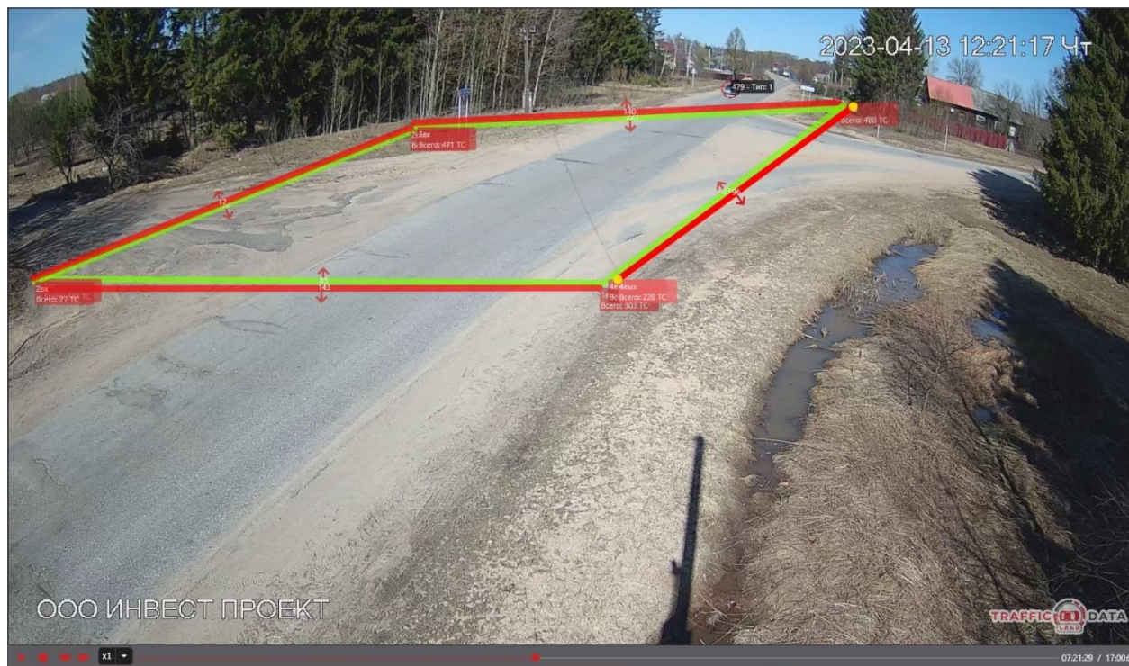
Рисунок 2.8.6 – Скриншот видео и схема подсчета интенсивности на узле № 5 – а/д подъезд к с. Кушалино - ул. Колхозная -ул. Лесная
