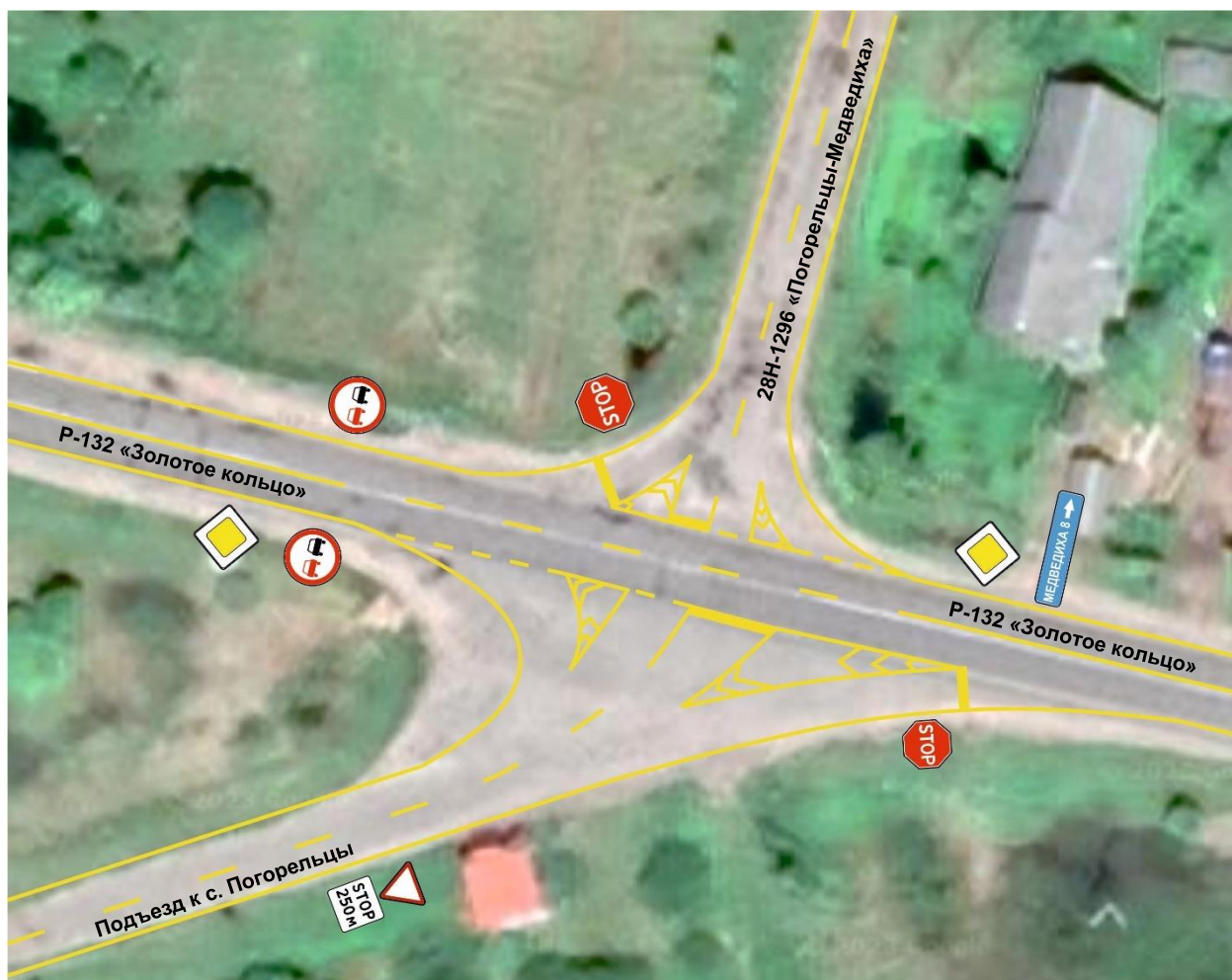
Рисунок 3.2.2 – Предлагаемая схема ОДД на узле 2 – Р-132 «Золотое кольцо» - а/д 28Н-1296 «Погорельцы-Медведиха»
